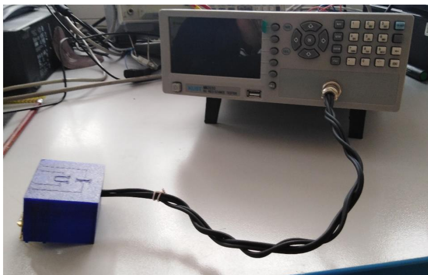
Obrázek 16: Miliohmometr Kust MM2030
