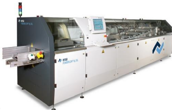
Obrázek 4: Zařízení pro pájení vlnou [15]
